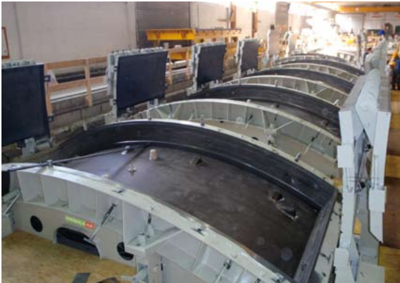
Tübbingschalungen in der Produktionshalle
